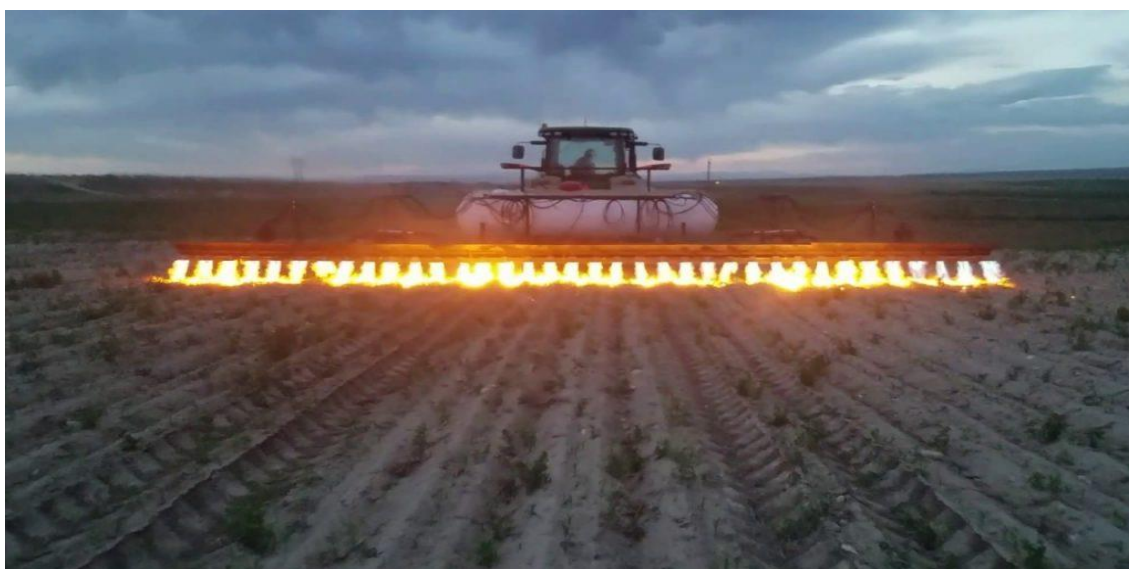
Figura 5. Trator “lança-chamas” controla ervas daninhas sem a necessidade de produtos químicos. Fonte: https://engenhariae.com.br/ , 2023.
